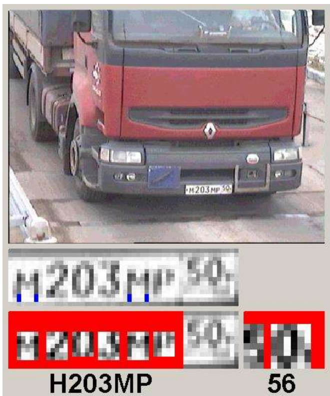
Рис. 2. Распознавание номерного знака автотранспортного средства.
