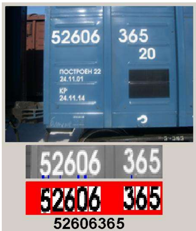
Рис. 3. Распознавание номера вагона.
