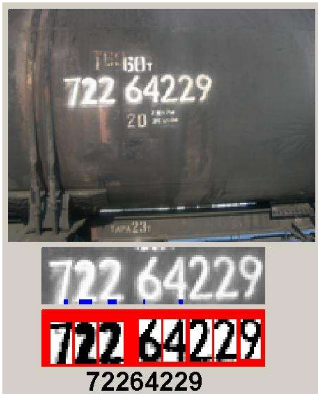
Рис. 5. Распознавание номера цистерны.
