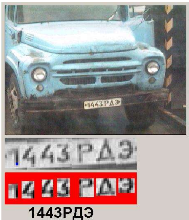
Рис. 1. Распознавание номерного знака автотранспортного средства.
