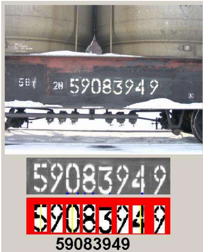
Рис. 7. Распознавание номера платформы.
