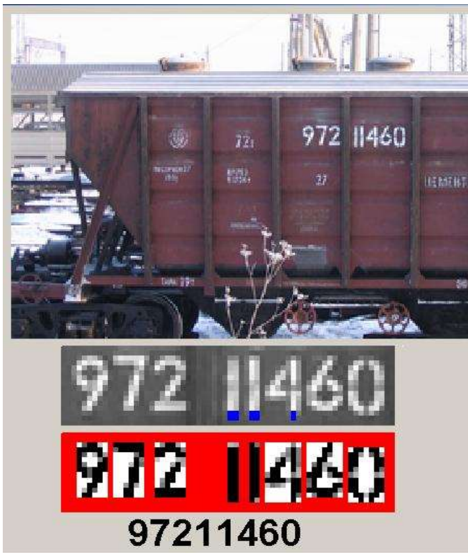
Рис. 6. Распознавание номера вагона.
